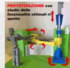
*Simulazione di rotazione del SISTEMA DI MANIPOLAZIONE MANUALE O SEMI-AUTOMATICO onde consentire una facile presa del pezzo da spostare nelle diverse postazioni di lavoro*
